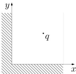
Die Abbildung zeigt eine Konfiguration aus zwei senkrecht zueinander liegenden, geerdeten Metallplatten ( $\phi = 0$ ) und einer Punktladung  $q$ . Die Metallplatten seien in der positiven  $x$ - $z$ - bzw.  $y$ - $z$ -Halbebene (also  $y = 0$  und  $x > 0$  bzw.  $x = 0$  und  $y > 0$ ) unendlich ausgedehnt. Die  $z$ -Achse weise aus der Papierebene heraus. Die Punktladung sei am Ort  $(x_q, y_q, 0)$  positioniert.
